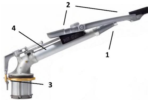
Abb. 5: Der Starkregner mit Düse (1), dem Drive-Spoon bzw. Ablenkhebel (2), Sektorbegrenzung (3) und dem Durchflussrohr (4) (verändert nach Nelson (2021)).
