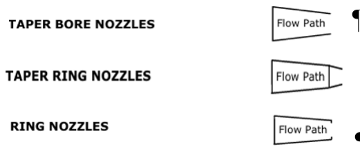
Abb. 6: Bildliche Darstellung der drei Düsen Taper Bore Düse (1), Taper Ring Düse (2) und Ring Düse (3) (verändert nach Tang und Chen (2022)).
