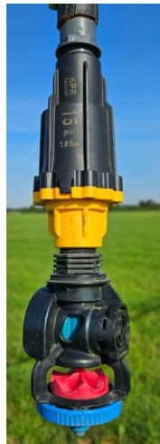
Abb. 23: An Düsenwagen installierte Düse mit einem optimalen Druck von 1,0 Bar (Eigene Aufnahme).
